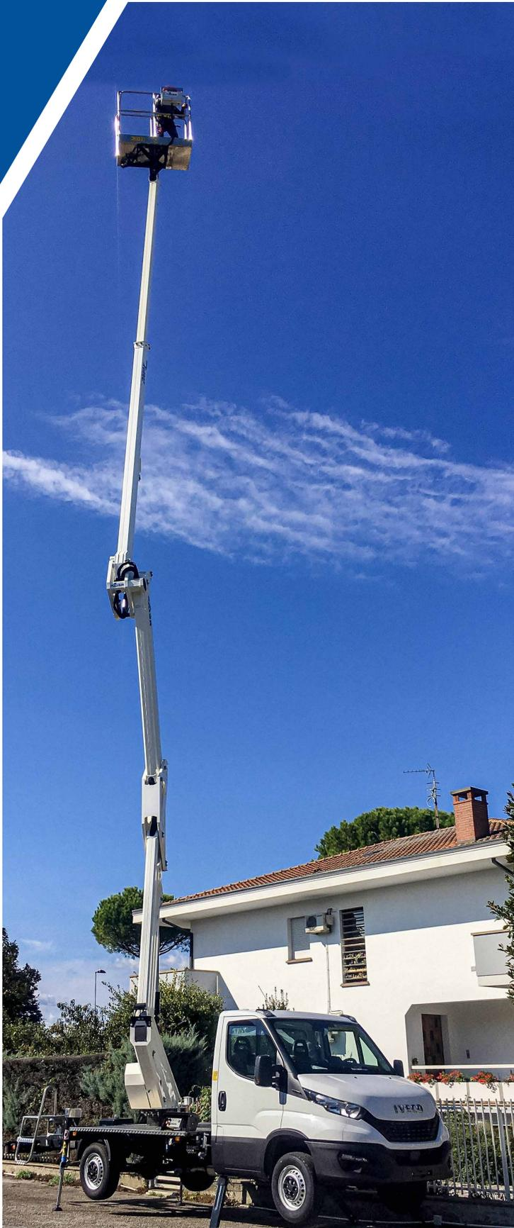
La piattaforma GSR doppia articolata B200PX consente di raggiungere uno sbraccio orizzontale massimo di 9 metri, mantenendo la stabilizzazione “in sagoma” e risultando particolarmente compatta. Semplice da usare e tecnologicamente avanzata, questa macchina mantiene i tradizionali livelli di rigidità e robustezza della gamma PX e conferma gli standard di alta qualità ed innovazione dei prodotti GSR.
