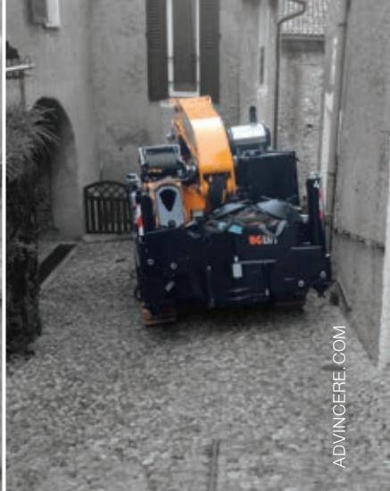
Meno centimetri in altezza, lunghezza e larghezza ed un controllo millimetrico di avanzamento, consentono il raggiungimento di luoghi precedentemente preclusi a gru con tali prestazioni. Dimensioni record 5070X1850, H 2615 mm.
